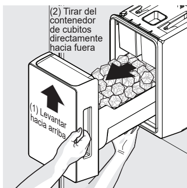
Extracción del contenedor de cubitos
