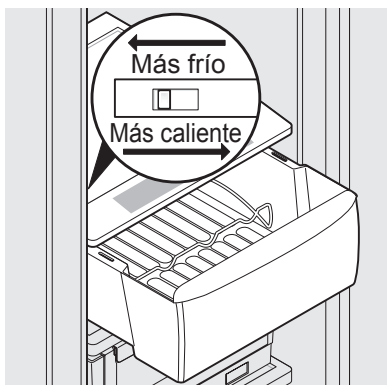
Cajón de enfriamiento con control de temperatura
