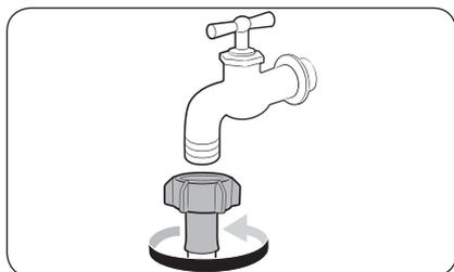
7. Si usa una llave del agua de tipo rosca, conecte el adaptador tipo rosca provisto a la llave del agua, como se muestra en la ilustración.
