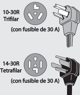
Las secadoras eléctricas deben tener un cordón eléctrico aprobado por UL (no se incluye con los electrodomésticos excepto los fabricados para la venta en Canadá).
