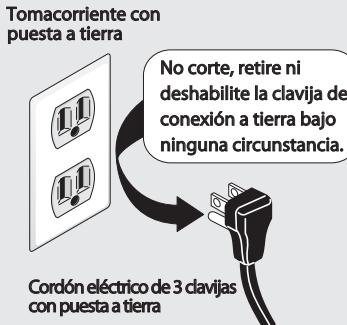
Evite el riesgo de incendio o de choque eléctrico. No utilice un enchufe adaptador ni un cable de extensión, y tampoco quite la espiga de conexión a tierra del cable de alimentación eléctrica. De lo contrario podría provocar lesiones graves, incendios o incluso la muerte.
