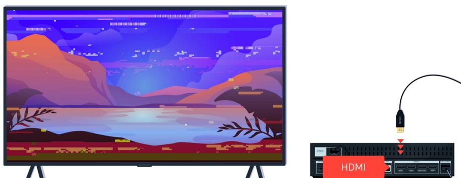
Si el dispositivo externo es compatible con los videos UHD 4K y UHD 8K, utilice el cable HDMI exclusivo para cada resolución.
