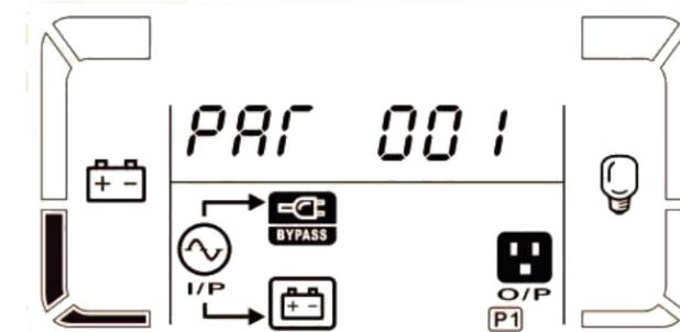
4. Verifique el voltaje de salida en el modo de derivación con un solo disyuntor de salida encendido.
