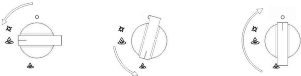
Quemador ENCENDIDO, llama alta Quemador ENCENDIDO, llama pequeña (modo de ahorro) Quemador apagado
