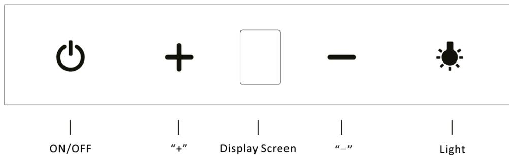
La pantalla muestra **8** cuando está encendido. Las luces indicadoras están encendidas y se apagarán después de 1 segundo. El zumbador suena y la luz del botón ON / OFF se oscurece.
